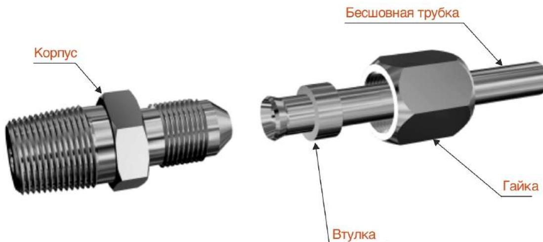
Данная конструкция герметичное соединение и после многократной сборки. Для производства прямых фитингов, гаек и втулок используются прутковые заготовки, а угловые фитинги и переходники изготавливаются из поковок.
