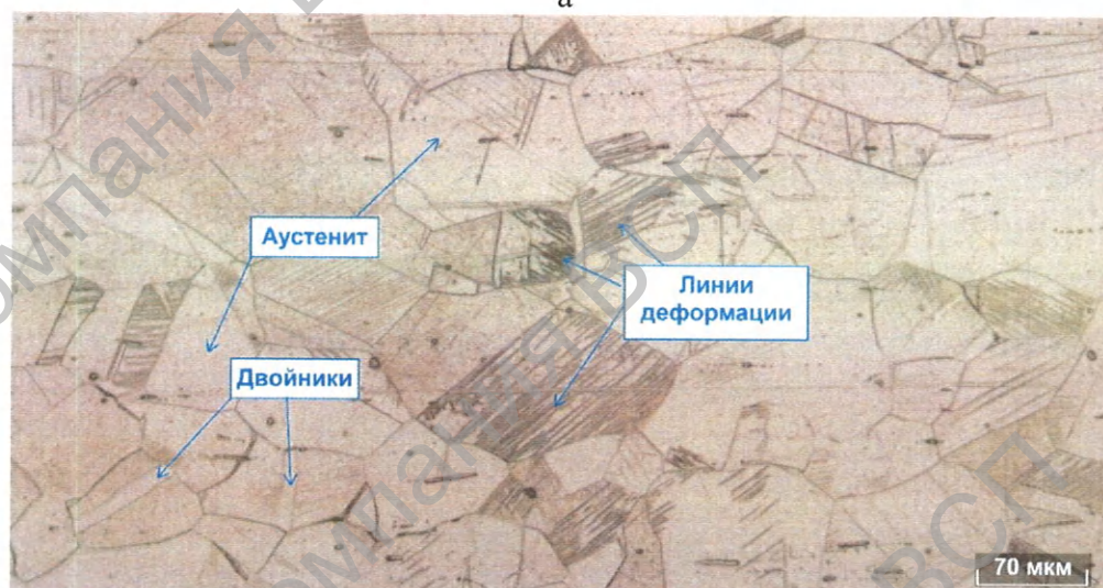
Рисунок 6.16. Микроструктура манифольда Ну-Lok а – увеличение 100х; б – увеличение 200х
