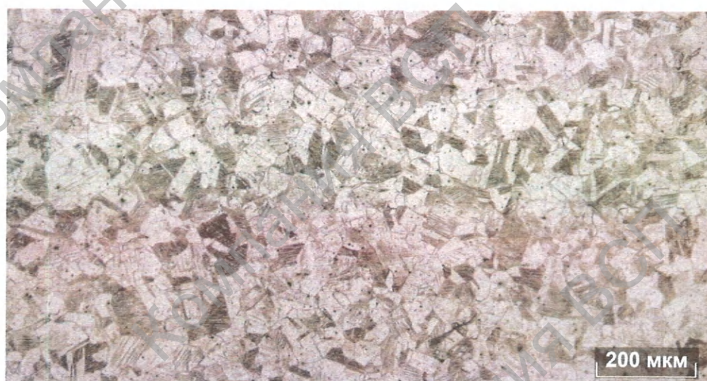
Рисунок 6.20. Микроструктура кольца переднего S-Lok (стр. 2 из 2): б – увеличение 200х
