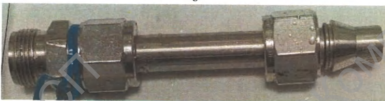
Рисунок 3.4. Вид образцов по прошествии 240 часов после начала испытаний в камере соляного тумана (стр. 1 из 2): а – Havi, б – DK-Lok, в – Hy-Lok
