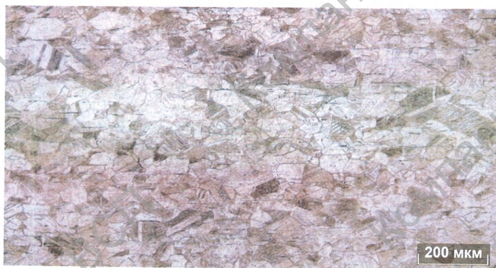
Рисунок 6.20. Микроструктура кольца переднего S-Lok (стр. 1 из 2): а – увеличение 100х
