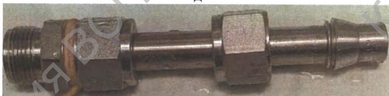
Рисунок 3.4. Вид образцов по прошествии 240 часов после начала испытаний в камере соляного тумана (стр. 2 из 2): г – S-Lok, д – Fitok, е – RizurLok
