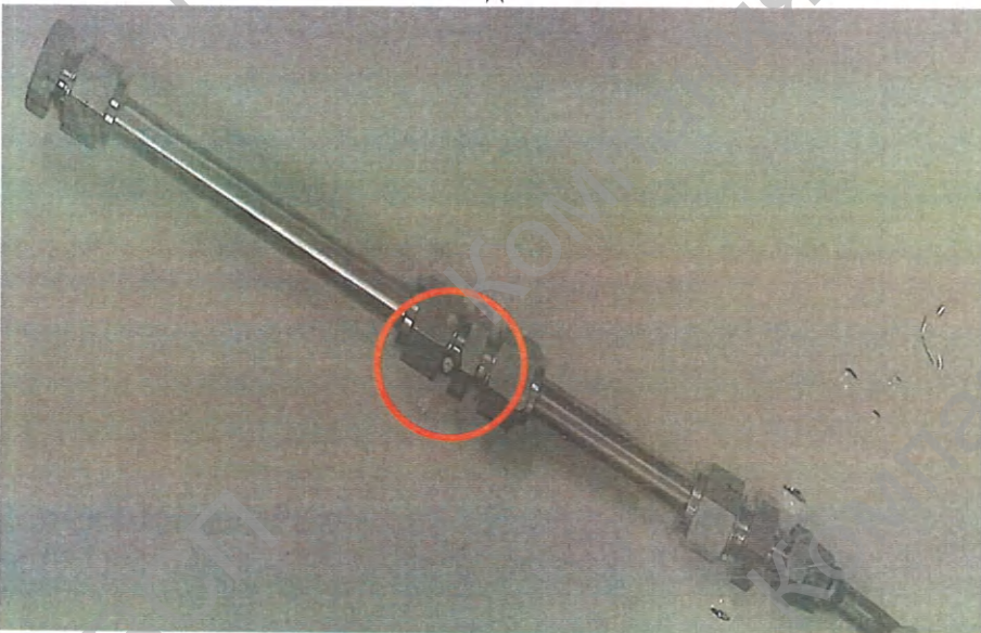
Рисунок 1.2. Вид сборных образцов при испытаниях внутренним давлением на протечку (стр. 2 из 2): в – Hy-Lok, г – S-Lok, д – Fitok, е – RizurLok
