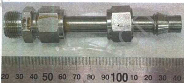
Рисунок 3.6. Вид образцов после испытаний в камере соляного тумана (стр. 1 из 2): д – Fitok, е – RizurLok
