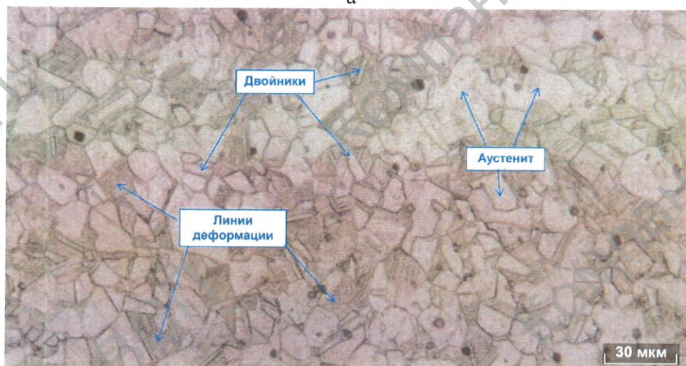
Рисунок 6.15. Микроструктура манифольда Navi: а – увеличение 100х; б – увеличение 500х
