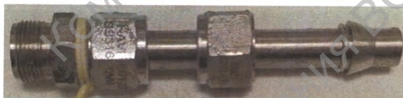
Рисунок 3.3. Вид образцов в камере соляного тумана
