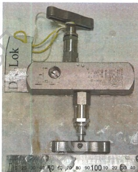
Рисунок 3.5. Вид манифольдов по прошествии 240 часов после начала испытаний в камере соляного тумана (стр. 1 из 3): а – Havi, б – DK-Lok
