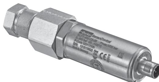
Все преимущества аналоговых датчиков SCPT сочетаются здесь с перспективной технологией шины CAN. Простое подключение с помощью быстроразъемного резьбового соединения SPEEDCON®. Функциональность Plug-&-Play с минимальными затратами на настройку.
