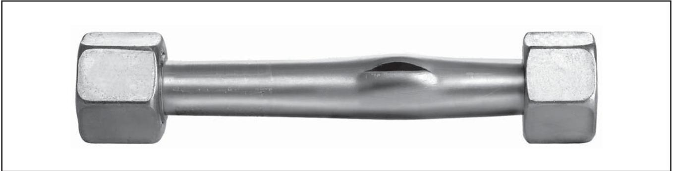
Правильно собранные трубные фитинги Parker обеспечивают герметичное соединение, вплоть до прорыва трубы. Практика показывает, что прорывов, повторного зажатия и утечек можно избежать, следуя настоящей инструкции по ТБ. Пожалуйста, сверьтесь с вашими методиками работы с фитингами.
