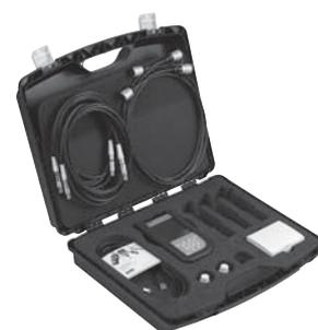
Новый **Serviceman Plus** производства **Parker** – это портативный измерительный прибор, чрезвычайно надежный и простой в обращении. Он предназначен для решения различных измерительных задач в мобильной гидравлике и стационарных гидравлических установках.
