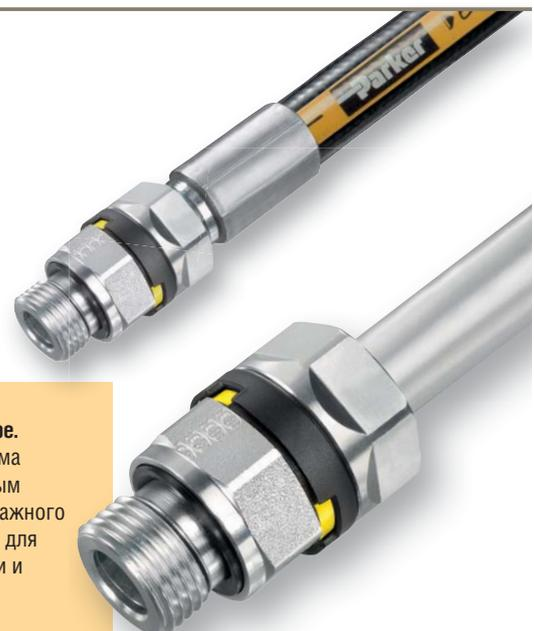
**Проверенная на практике технология Dry Technology.** Эластомерное уплотнение большого сечения на стороне трубы и коррозионностойкое покрытие поверхностей без применения Cr (VI). Можно использовать при номинальном давлении 800 бар (серия S) и до 500 бар (серия L).
