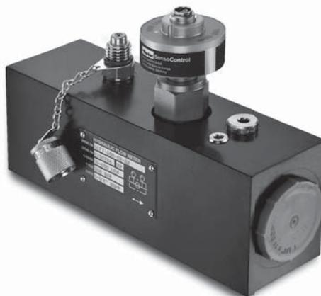
Поток гидравлической жидкости вращает турбинное колесо, и таким образом оно приводится в движение. Полученная в результате частота преобразуется электроникой в цифровые сигналы. Выполняется компенсация помех из-за создающегося потока. Благодаря малому гидродинамическому сопротивлению  $Q_R$  гидравлический контур работает с малыми потерями.
