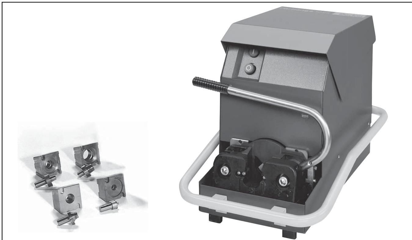
Станок Parflange® 1025 предназначен для холодной деформации трубных соединений O-Lok® и Triple-Lok®. В нем используется запатентованная технология орбитальной развальцовки Parflange®. Станок Parflange® 1025 равномерно сжимает материал трубы, достигая высокой прочности соединения благодаря полированной поверхности конца трубы. Фланцевые втулки O-Lok® и SAE надежно крепятся на конце трубы, что дает очень жесткое трубное соединение высокого давления.
