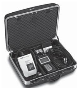
**Parker Service Master *Easy*** – это переносной многоканальный прибор для одновременного измерения важных гидравлических величин:
