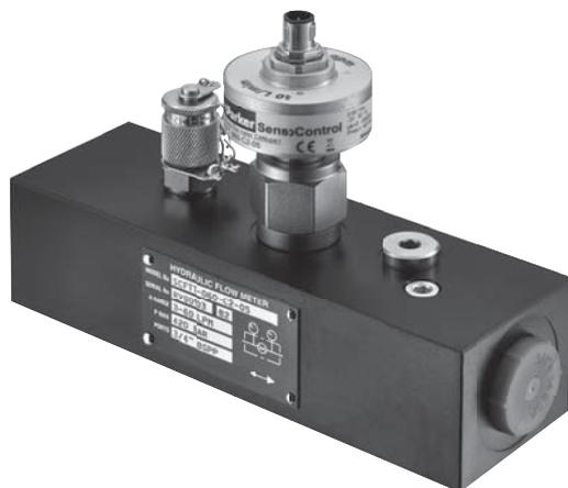
Поток гидравлической жидкости вращает турбинное колесо, и таким образом оно приводится в движение. Полученная в результате частота преобразуется электроникой в цифровые сигналы. Выполняется компенсация помех из-за создающегося потока. Благодаря малому гидродинамическому сопротивлению  $Q_R$  гидравлический контур работает с малыми потерями.
