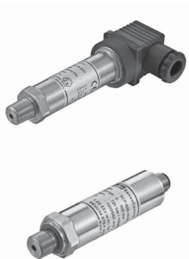
Датчик **SCP-EX** соответствует требованиям Директивы 94/9/ЕС и может быть настроен для работы во взрывоопасной зоне класса 1. Благодаря наличию соответствующих защитных цепей в случае неисправности активируются функции защиты от изменения полярности, защиты от перенапряжения и ограничения рассеяния мощности. Возможности его обширного промышленного применения гарантируются высокой точностью и надежной, компактной конструкцией.
