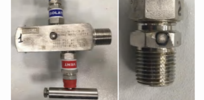
Рисунок 2.1. Образцы №1 и №2 после испытания на воздействие соленого тумана
