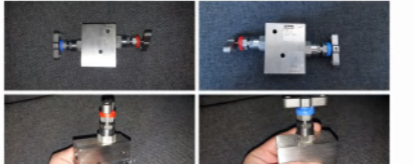
Рисунок 3 – Визуальный осмотр Манифольды 2VM-SS-8-R-SG после проведения испытаний
