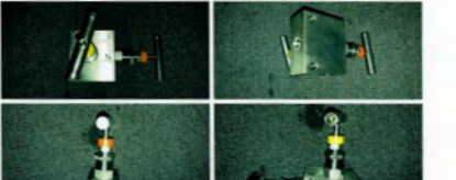
Рисунок 3 – Визуальный осмотр Манифольды 2VM-SS-8-R-SG после проведения испытаний
