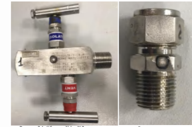
Рисунок 2.1. Образцы N1 и N2 после испытания на воздействие солевого тумана
