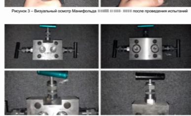
Рисунок 4 – Визуальный осмотр Манифольды N1011 и N1012 после проведения испытаний
