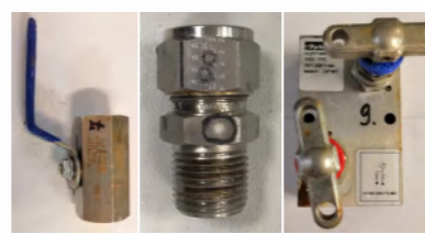
Рисунок 2.4. Образцы N7, N8 и N9 после испытания на воздействие солевого тумана
